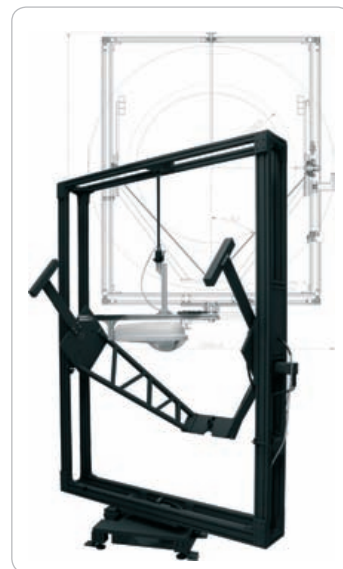
Obr. 2 Goniofotometer na meranie fotometrických parametrov svietidiel (Zdroj: TechnoTeam Bildverarbeitung Ilmenau)
